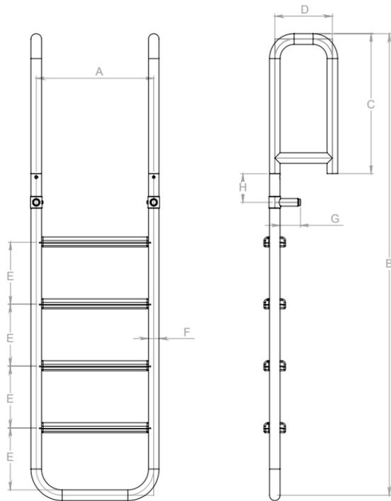
Realizzate in titanio gr. 2 per sala macchine, da bagno, laterali e facilmente smontabili per lo stivaggio.
